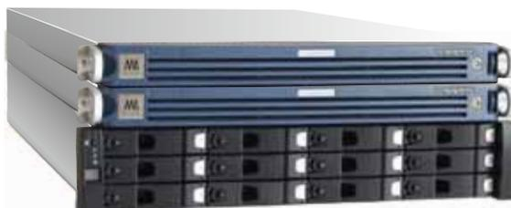
CLASTOR2100-HAWS は、フェールオーバークラスター技術を使用し、10Gb Etherport を持つアクティブ - スタンバイ構成のサーバーと、最大ストレージ容量 240TB、デュアルコントローラー搭載 8Gb-FC RAID 装置からなる、冗長化クラスター型ファイルサーバーパッケージです。
