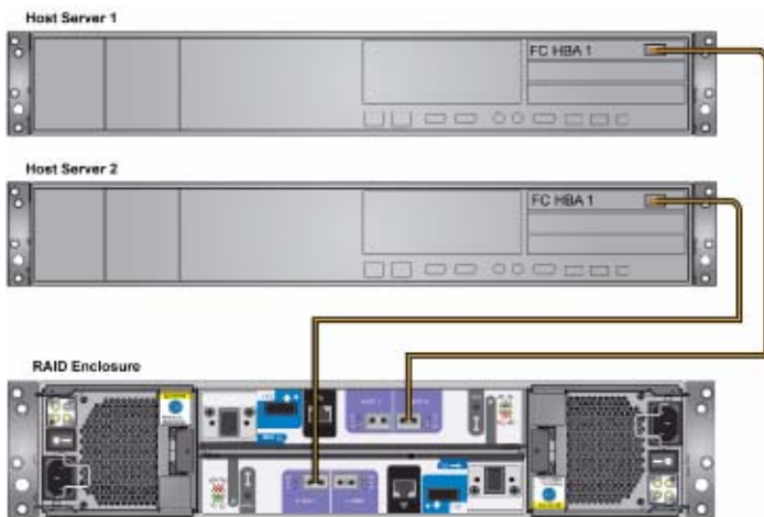
図3-27 デュアルホスト、シングルHBA、デュアルコントローラーのケーブル接続
