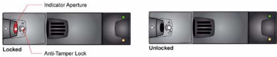
図3-14 取り外し防止ロックの設定
