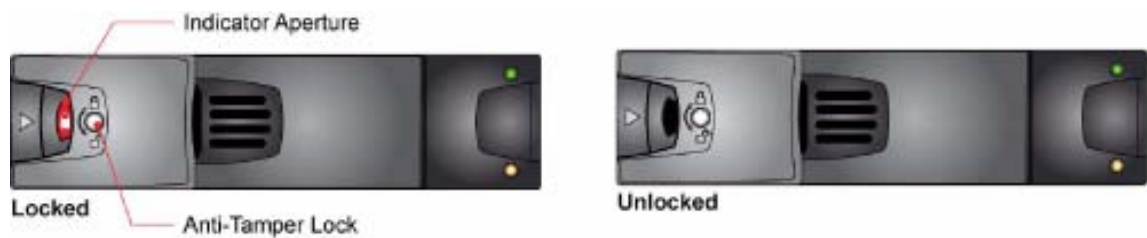
図6-18 アンチタンパーロックの解除
