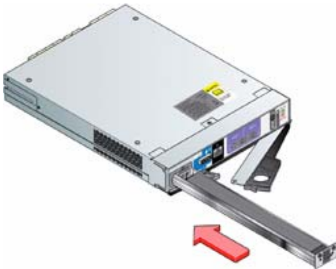
図6-15 バッテリーモジュールのインストール
