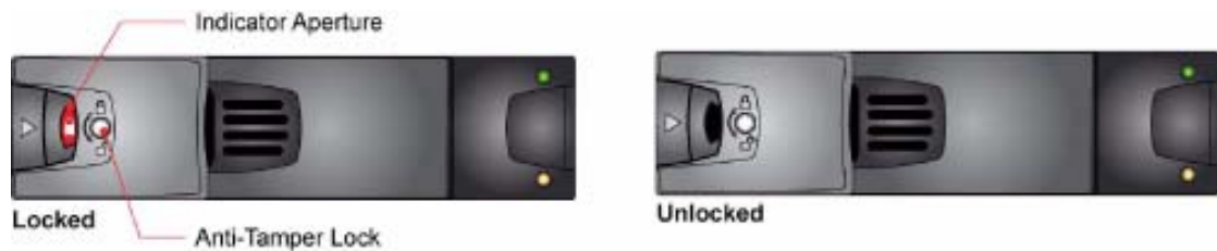
図3-8 アンチタンパーロックの解除
