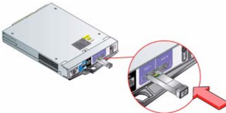
図6-17 SFPトランシーバーのインストール
